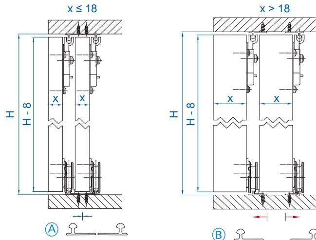
Способ монтажа направляющих в зависимости от толщины двери. Внимание: в случае, когда дверь снабжена алюминиевыми профилями или выпуклыми ручками, их размер следует учесть при расчете толщины двери.
