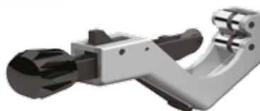
приспособление для резки труб  $\varnothing 6 \div 45$
