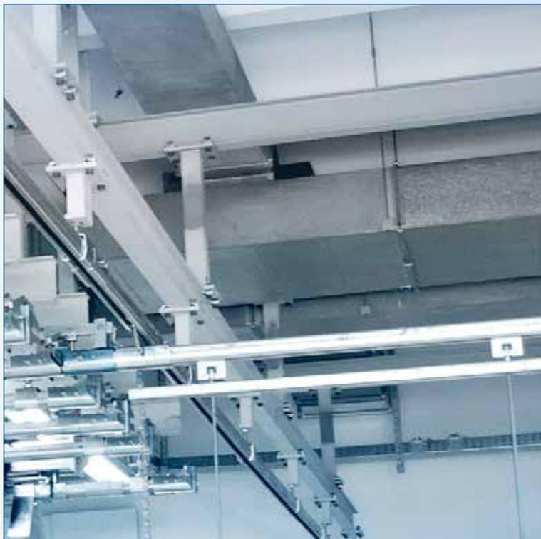
Системы технологического подвешного транспорта позволяют создать надежные решения, предназначенные для перемещения элементов весом до 2 тонн. Системы выполнены из оцинкованной нержавеющей стали или алюминия.
