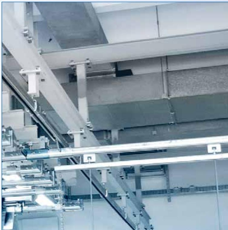
**Системы технологического подвесного транспорта позволяют создать надежные решения, предназначенные для перемещения элементов весом до 2 тонн. Системы выполнены из оцинкованной нержавеющей стали или алюминия.**
