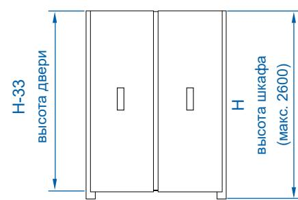
**НАГРУЗКА ДВЕРНОГО ПОЛОТНА** макс. 9 кг
