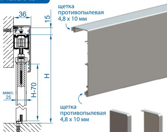
маскировочная планка, алюминиевая, Herkules Glass с заглушками, для дверей до 25 мм направляющие крепить, используя настенные скобы до 25 мм
