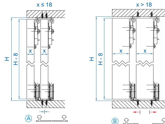
Способ монтажа направляющих в зависимости от толщины двери.
