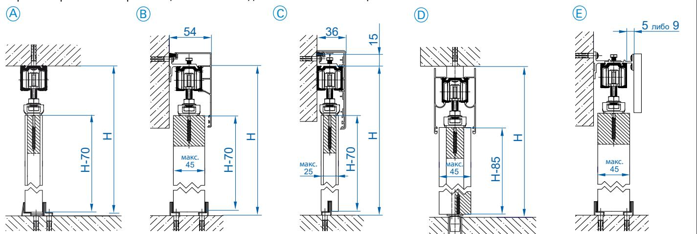
A - направляющая, прикрепленная к потолку, нижний проводник охватывает дверь;
