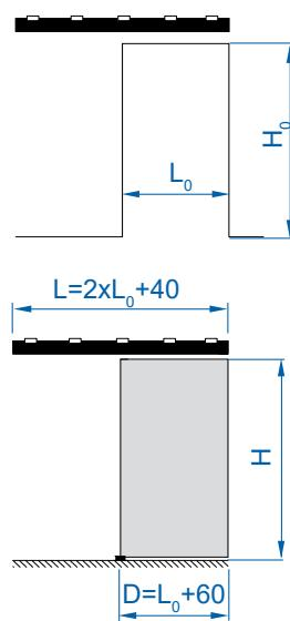
**НАГРУЗКА ДВЕРНОГО ПОЛОТНА** макс. 45 кг
