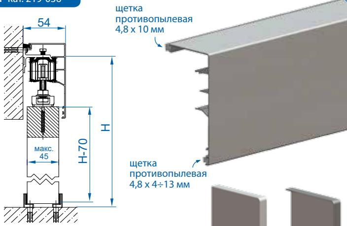
маскировочная планка, алюминиевая, Herkules Wood, с заглушками, для дверей толщиной до 25 мм направляющие крепить, используя настенные скобы до 45 мм
