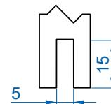
Фреза в нижнем торце двери для проводника
